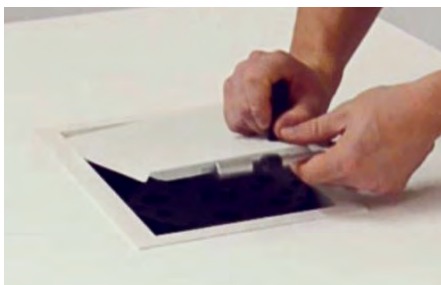
1. Gitter mit DE-X Tool herausnehmen Das magnetische DE-X Tool an einer Ecke flach am Frontgitter ansetzen und das Gitter abheben und herausklappen. Dann mit der Hand entfernen.
