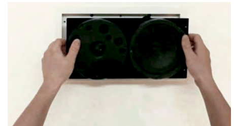
9. Lautsprecher-Modul einsetzen Das Lautsprecher-Modul mit den mitgelieferten Schrauben M 4 x 10 am Einbau-rahmen fixieren.
