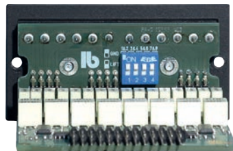
DIP-Schalter auf der Innenseite der Module 8xIN-SYM/8xIN-CINCH. Schalterstellung oben = GROUND (ON) Schalterstellung unten = LIFT
