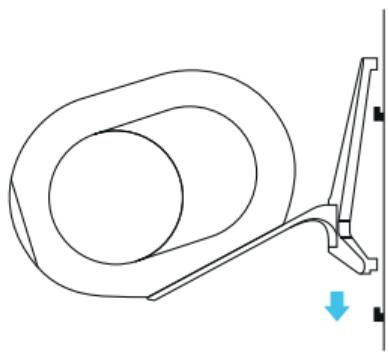
Fixez PHANTOM et son support GECKO en les crochetant sur les 4 embouts simultanément.
