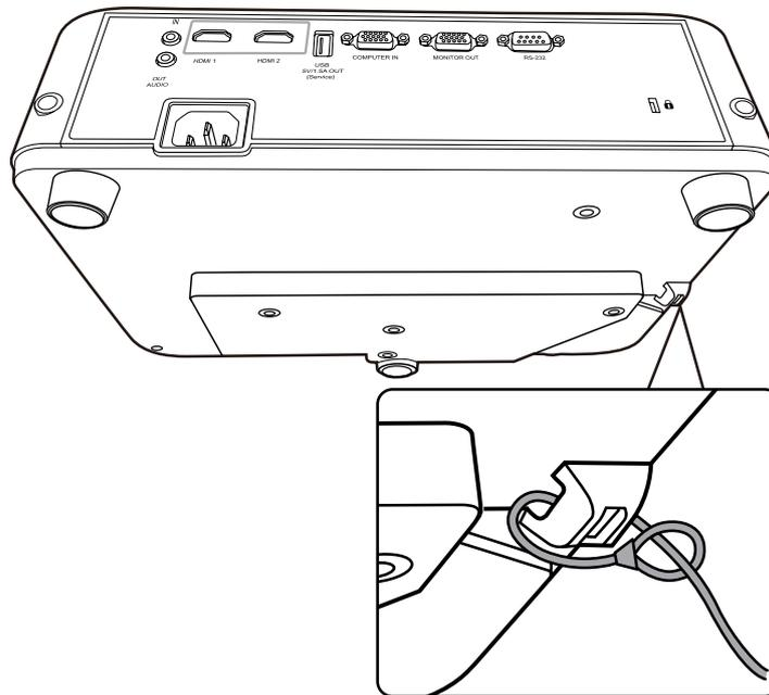
**HINWEIS:** Der Sicherheitssteckplatz kann auch als Sicherungsanker verwendet werden, wenn der Projektor an der Decke montiert wird.
